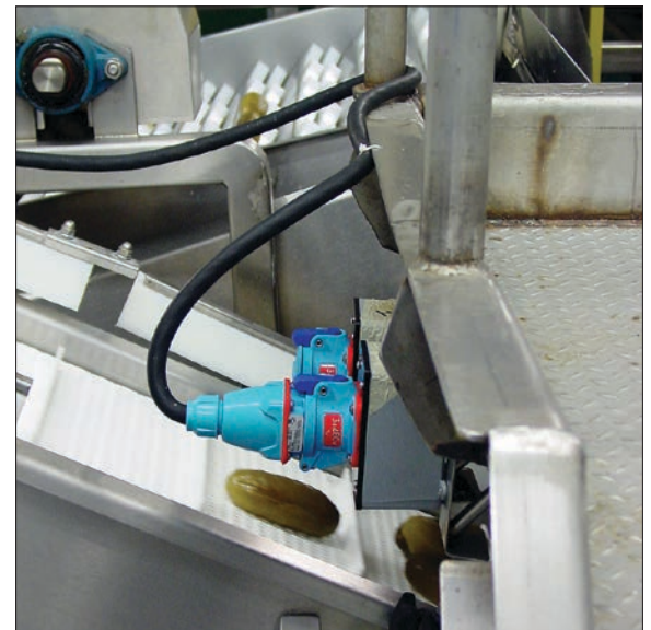
Los tomacorrientes Certificados como Seccionador MELTRIC cuentan con un botón rojo en el gatillo/interruptor "OFF", el cual puede ser utilizado como un interruptor de emergencia para bandas transportadoras.
