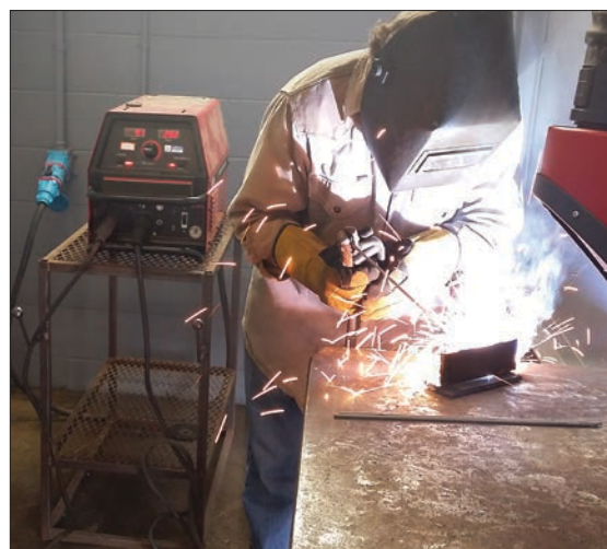
Cambiar el equipo para soldar en las estaciones de soldadura del Colegio Odessa es más fácil con los tomacorrientes Certificados como Seccionador MELTRIC. Cuentan con un mecanismo de interrupción integral que permite conectar y desconectar de forma segura, incluso a plena carga.
