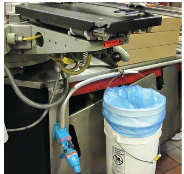
Los dispositivos Certificados como Seccionador MELTRIC cumplen con los requerimientos del NEC como seccionadores en "línea de vista". Los usuarios pueden conectar y desconectar de forma segura conexiones eléctricas a plena carga.
