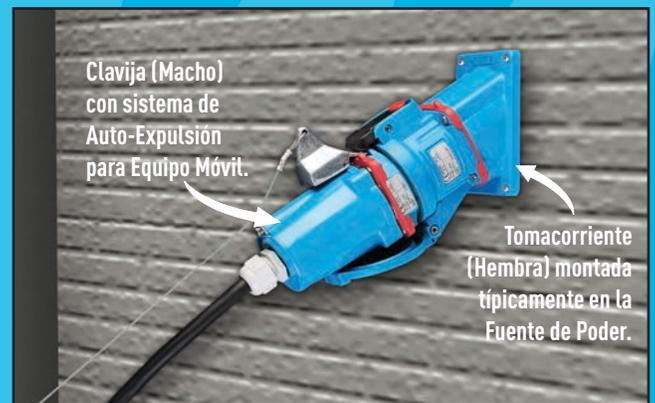
**Clavija (Macho) con sistema Auto-Expulsión:** Un mecanismo tipo "aleta de tiburón" es instalado en la clavija el cual está sujeto a un cable tensor. Cuando tensión es aplicada al cable, el mecanismo tipo "aleta de tiburón" eleva el gatillo con un movimiento de palanca, liberando la clavija con completa seguridad.
