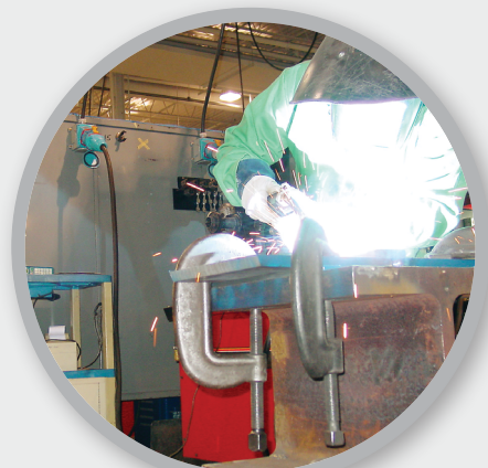
Tomacorrientes certificados como seccionador para soldadoras (al fondo) conectadas al electroducto , por medio de extensiones con cable.
